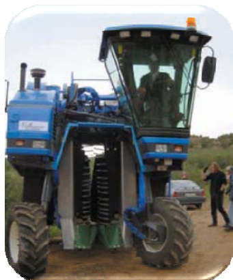
شکل ۱: ماشین برداشت زیتون از نوع Braud New Holland SB65
