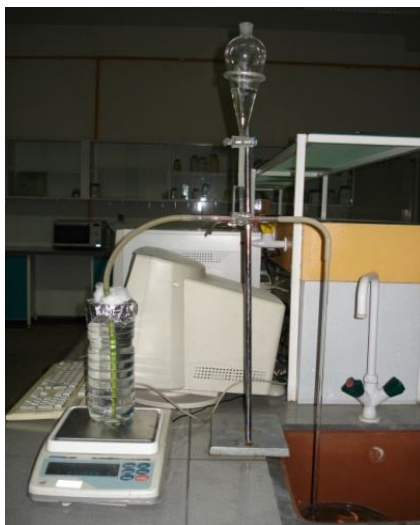
شکل 1: دستگاه طراحی شده بر اساس مدل اندازه گیری هدایت هیدرولیکی
