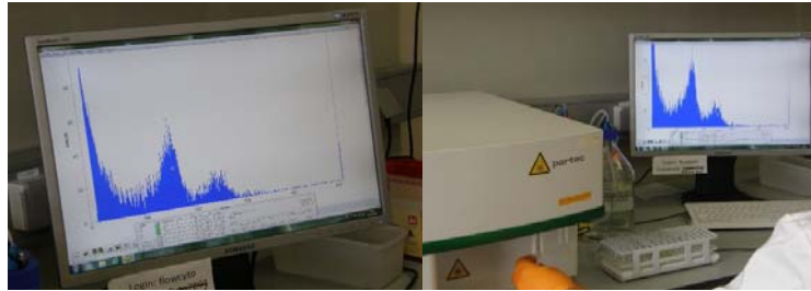
شکل ۲: تهیه نمونه و آنالیز سطح پلوئیدی نمونه با سیستم فلوسایتومتر (UV LED) مدل PARTEC (CytoFlowSpace)
