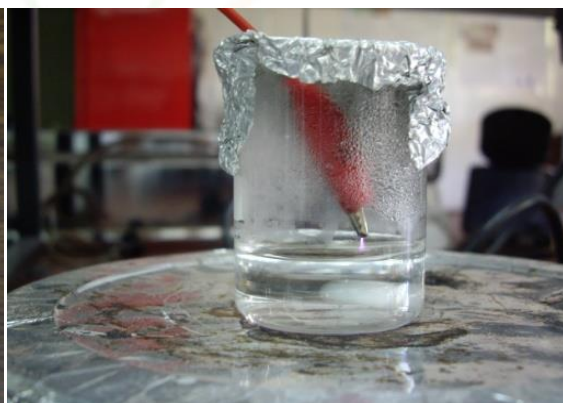
شکل ۱- سمت راست: تهیه آب فعال پلاسمایی، سمت چپ: جوانه‌زنی بذرهایی تیمار شده با آب فعال پلاسمایی
