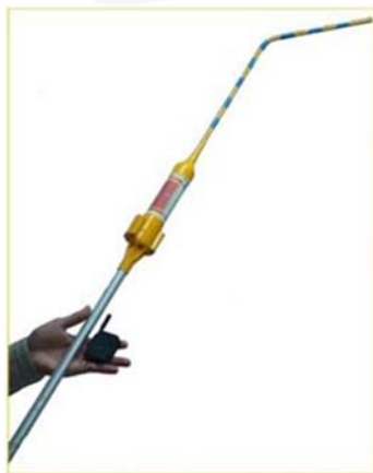
شکل ۱: گرده‌افشان مکانیکی (سمت راست) و گرده‌افشان الکتریکی (سمت چپ) مورد استفاده در تحقیق
